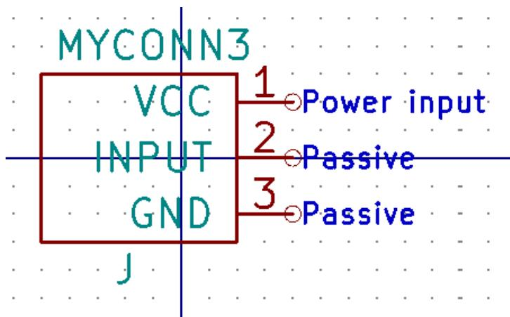
8. 如果要用黄色填充矩形，请在 首选项 → 选择颜色方案中将填充颜色设置为 黄色 4，然后使用 [e] 在编辑屏幕中选择矩形，选择 填充背景。
