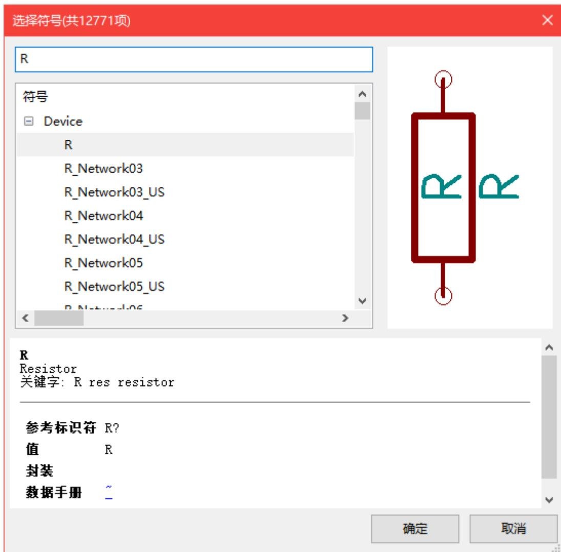
7. 双击它。这将关闭 **选择符号窗口**。通过单击元件在原理图中的的位置将其放置在原理图中。
