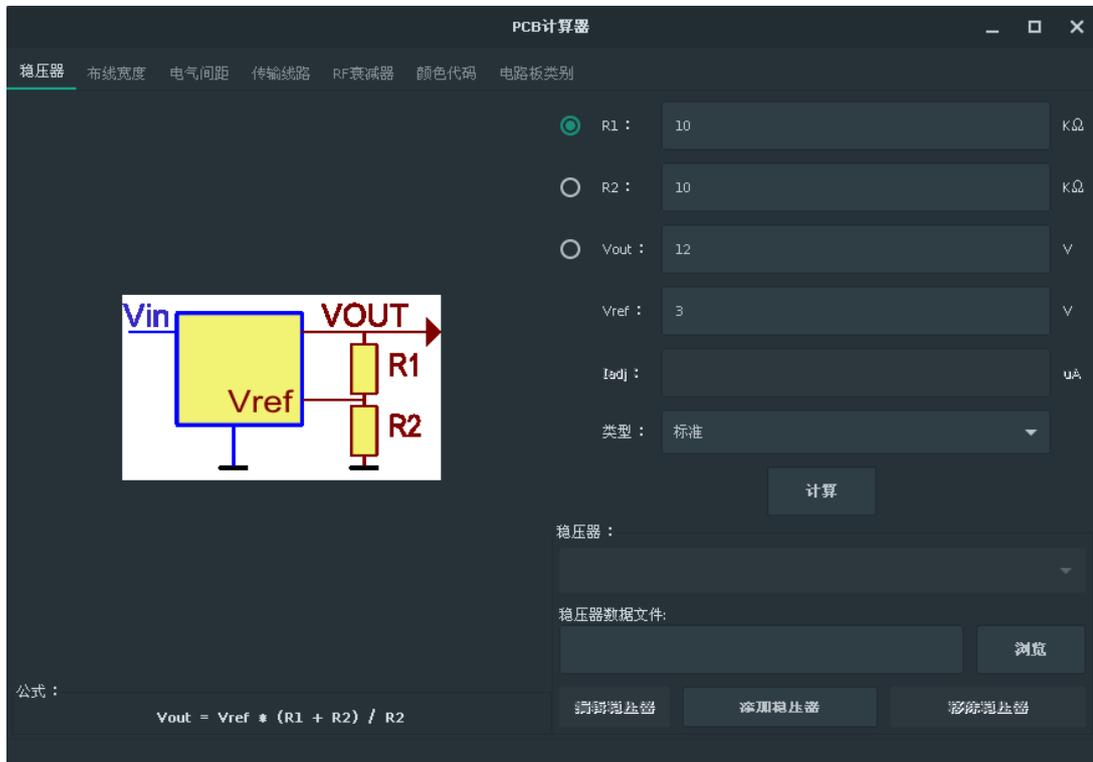
对于典型，作为参考电压  $V_{ref}$  和电阻器  $R1$  和  $R2$  的函数的输出电压  $V_{out}$  由下式给出：
