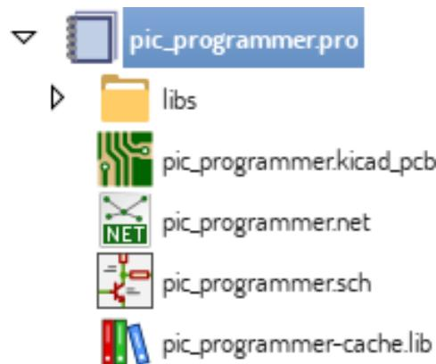
双击原理图文件运行原理图编辑器，在这种情况下打开文件 `pic_programmer.sch`。
