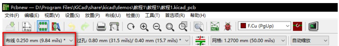
16. 如果您想添加更多的轨道宽度，请转到：**设置 → 设计规则 → 全局设计规则**选项卡，在此窗口的右下角添加您希望可用的任何其他宽度。然后，您可以在布置电路板时从下拉菜单中选择布线的宽度。请参阅下面的示例（英寸）。
