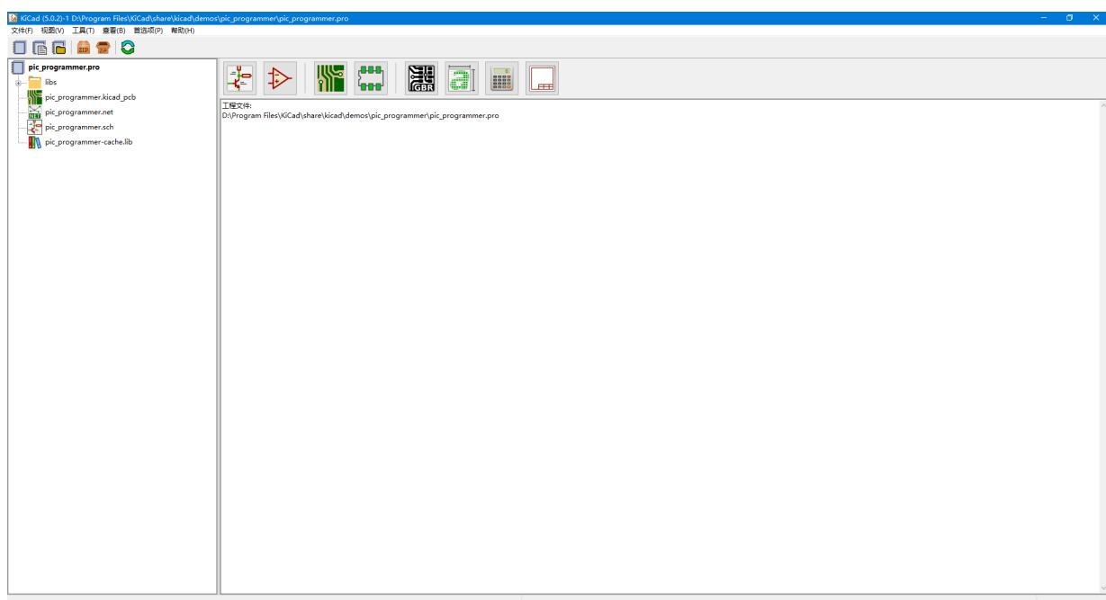
主 KiCad 窗口由工程树视图，包含用于运行各种软件工具的按钮的启动窗格和消息窗口组成。菜单和工具栏可用于创建，读取和保存工程文件。
