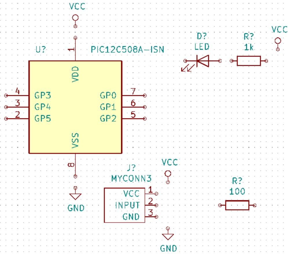
31. 接下来，我们将连接所有元件。单击右侧工具栏上的 放置电线图标 。
