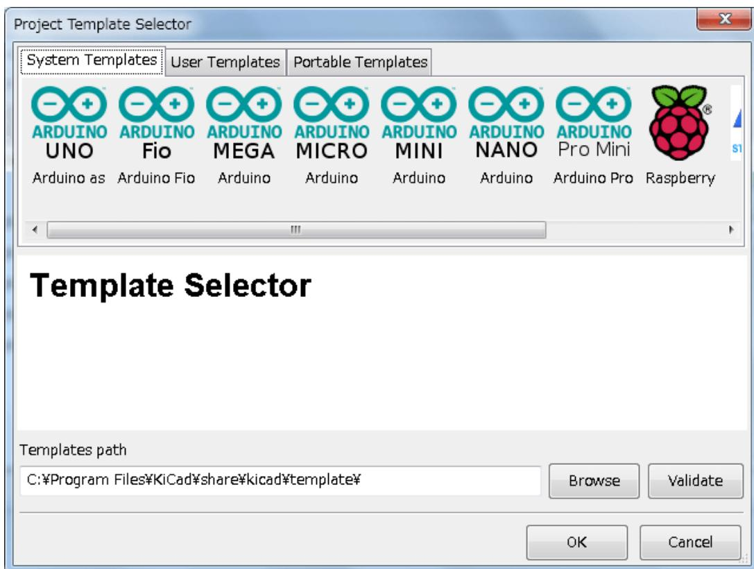
单击模板的图标将显示模板信息，再单击“确定”按钮将创建新工程。模板文件将复制到新工程位置并重命名以反映新工程的名称。
