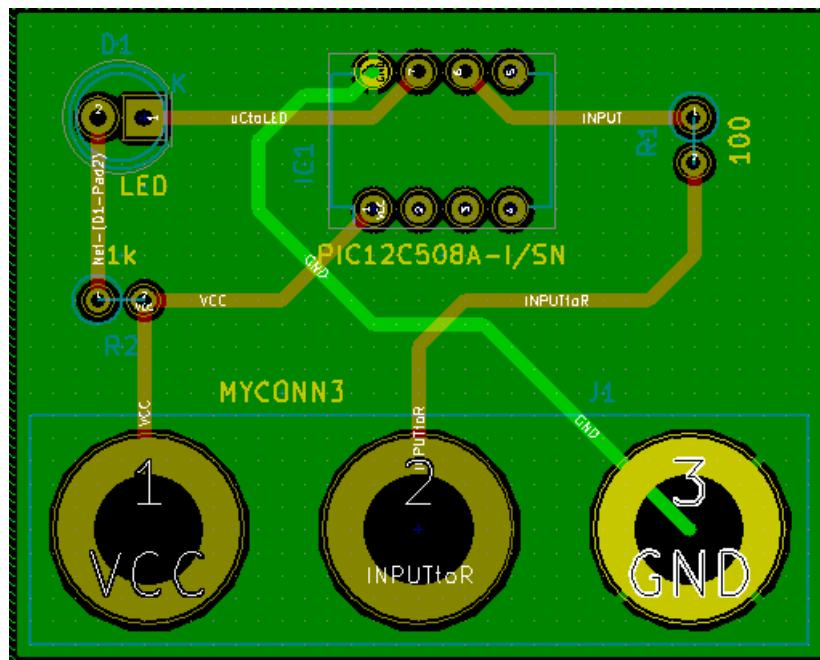
25. 单击顶部工具栏上的 执行设计规则检查图标 运行设计规则检查器。点击 开始 DRC。应该没有错误。点击 列表未连接。应该没有未连接的项目。单击 确定关闭 DRC 控制对话框。
