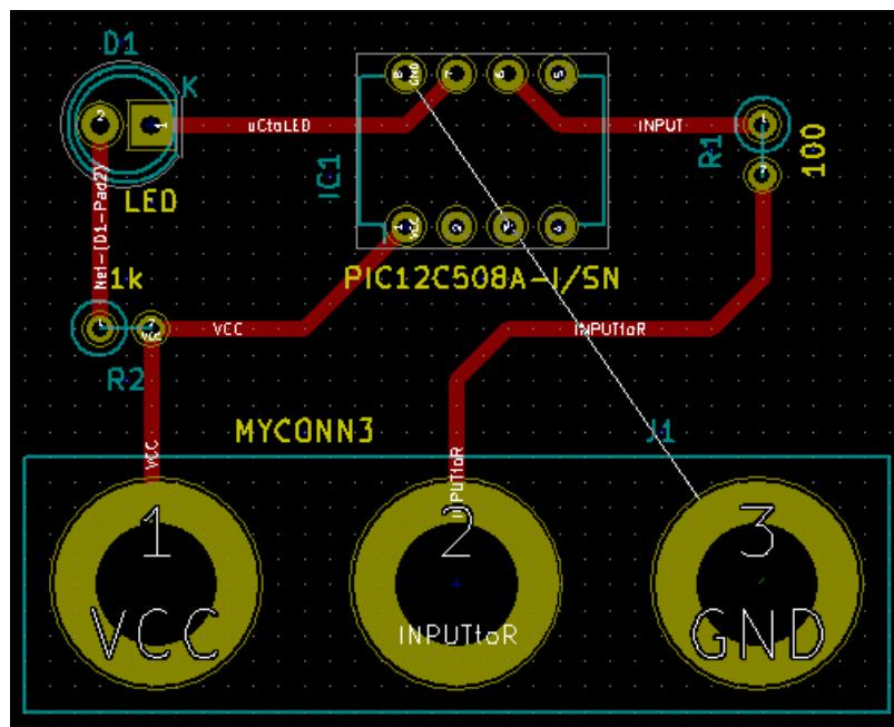
20. 现在让我们在 PCB 的另一个侧上运行布线。在顶部工具栏的下拉菜单中选择 **B.Cu**。点击 布线图标 。在 J1 的引脚 3 和 U1 的引脚 8 之间画一条线。这实际上没有必要，因为我们可以用地平面做到这一点。注意轨道的颜色是如何变化的。
