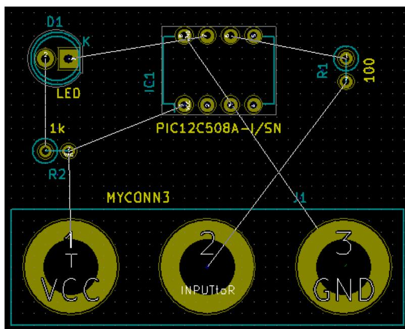
10. 注意 100 欧姆电阻的一个引脚如何连接到 PIC 元件的引脚 6。这是用于连接引脚的标记方法的结果。标签通常比实际的电线更受欢迎，因为它们使原理图更加杂乱。
